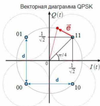
Рис. 2. Влияние эффекта Доплера на позицию точки сигнального созвездия «11» на векторной диаграмме модуляции QPSK (теоретическое) с указанием кодового расстояния d и предельных границ значений величины вектора ошибки (не более \frac{1}{\sqrt{2}} )
