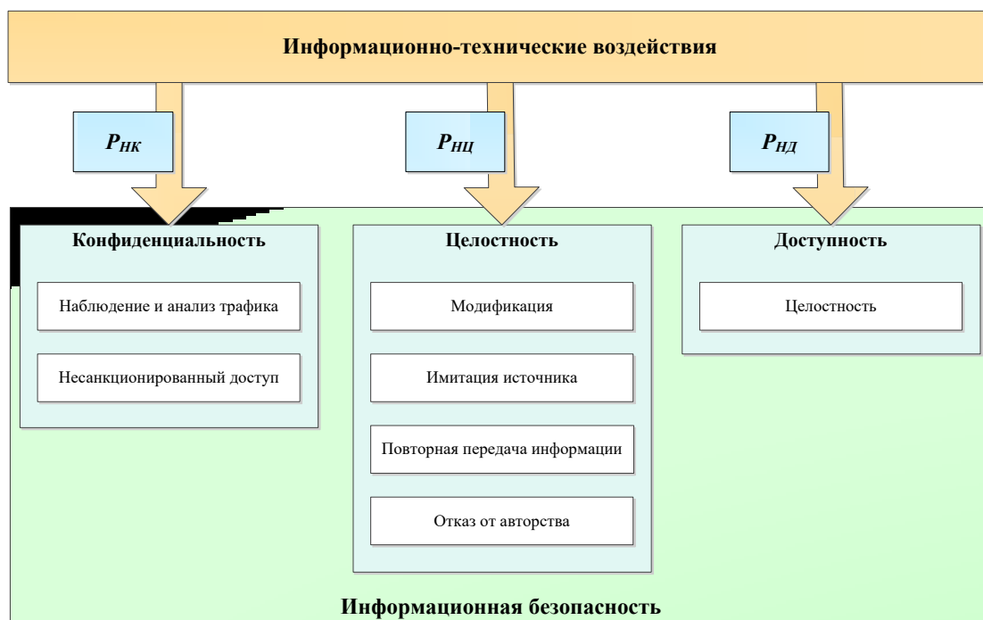
Рис. 9. Описание информационно-технических воздействий на параметры информационной безопасности
